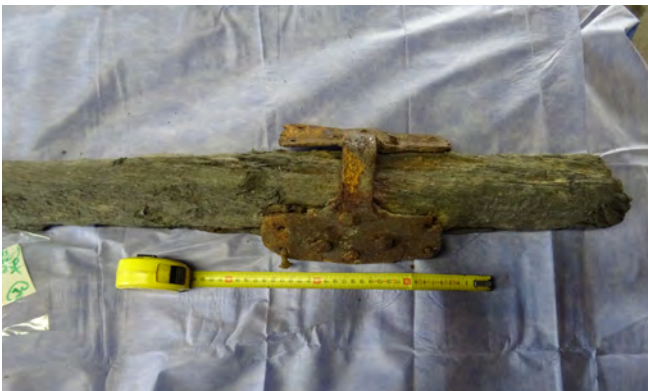
Afbeelding 20: Los aangetroffen sloopsonderdeel: achterstevan met vingerling
