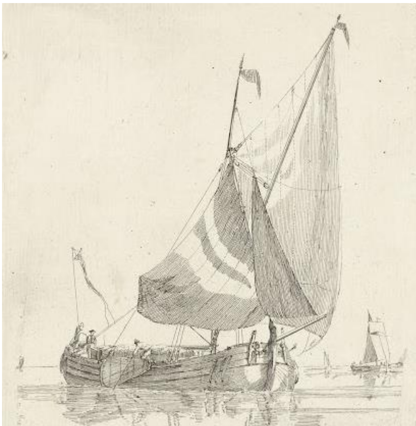
Afb. 13 Een Damloper. Ets van Gerrit Groenewegen, ca. 1800. Ook dit scheepstype behoorde tot de tjalkachtigen, onder andere door de gekromde voorsteven en de zeeg. 21
