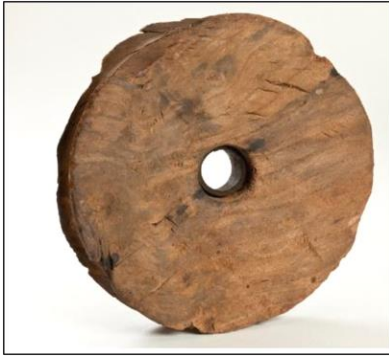
Inventarisnummer: NP40-I136 Omschrijving: Rol van een scheepsblok. Materiaal: Hout. Afmetingen: 17 x 17 x 3,3 centimeter. Vondstlocatie: Onbekend.
