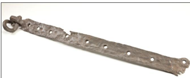
Inventarisnummer: NR13-II180 Omschrijving: Puttingsijzer. Materiaal: IJzer. Afmetingen: 62,5 4,2 x 1,7 centimeter. Vondstlocatie: Onbekend.
