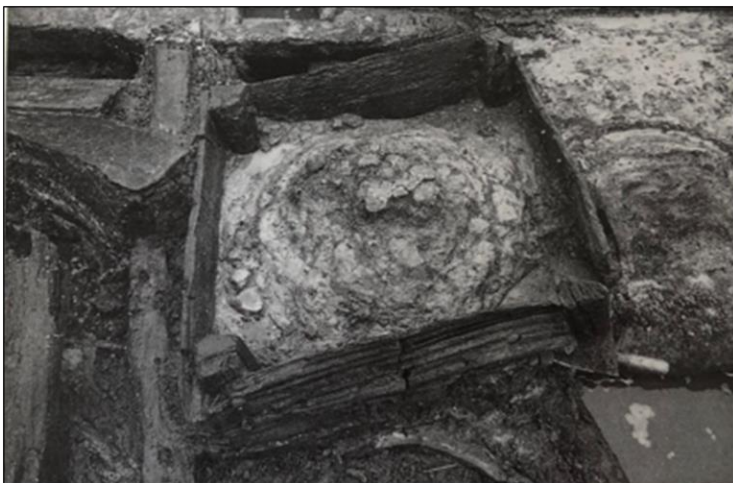
Figuur 42: Stookplaats van een eikenhoutenbak gevuld met leem van een 13e-eeuwse kogge op kavel OZ 43 in zuidelijk Flevoland. Bron: Vlierman 1992, 50.
