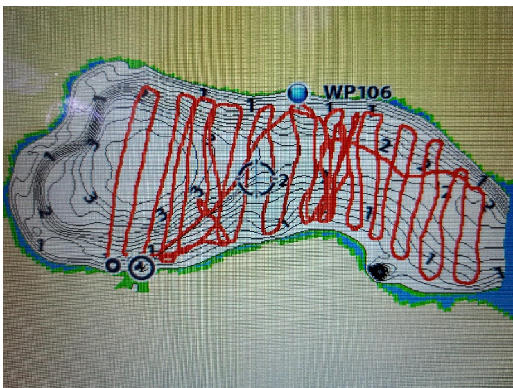
Figuur 8: Schermafbeelding side scan sonar gevaren raaien in noord-zuidrichting naar het oosten (eerste slag).
