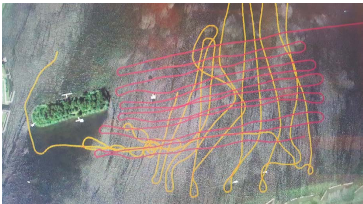
Figuur 11: Vaarpatroon opwaterfase Google Maps. NB De gele lijnen zijn niet recht dus minder of zelfs niet geschikt voor analyse. Echter door de combinatie met de rode lijnen kunnen eventuele anomalieën toch dubbel worden aangetroffen.
