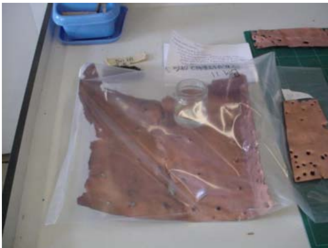
Afbeelding 4.11: Gestraald stuk koperplaat in plastic zak met potje ammoniak, fotonummer Dsc00791.
