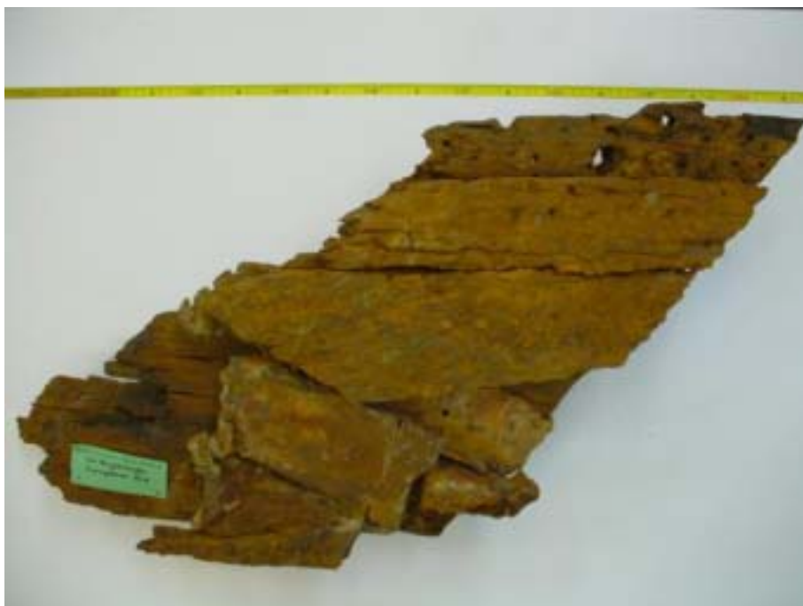
Afbeelding 4.7: Composiet 002, bestaande uit huidplank, dubbeling en lood, fotonummer Dsc00578.
