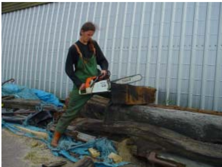
Afbeelding 6.1: Van een deel van de kiel wordt een plak hout gezaagd voor dendrochronologisch onderzoek.
