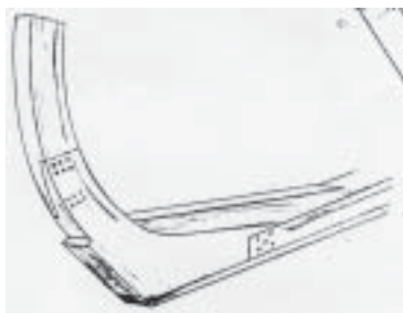
Afbeelding 6.2: Reconstructie van de voorsteven volgens Kamer. Over de platte las van de voorsteven en kielbalk, de kinnebak, wordt een slemphout geplaatst. Overgenomen uit Kamer 1995, p. 113.
